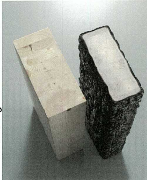
■鉄、木材の加熱による強度の変化※2
